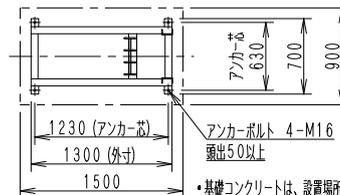
\*基礎コンクリートは、設置場所の地耐力により検討する事。
